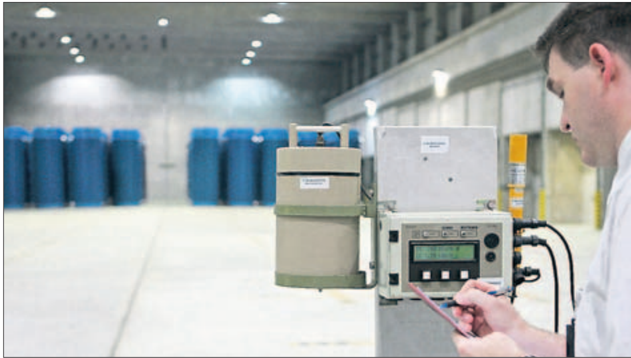
Ein Strahlenschutzbeauftragter misst in Gorleben die Radioaktivität der Castor-Behälter.
