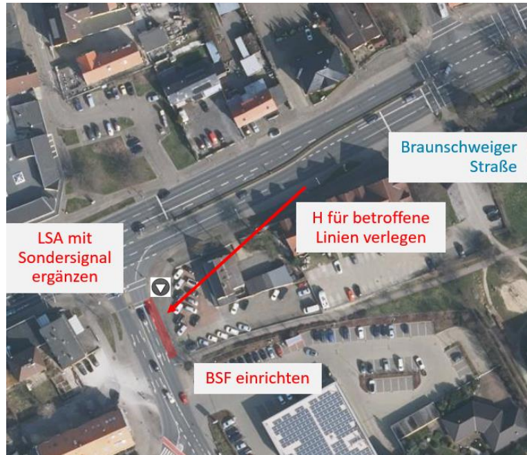
Abb. 25: ÖPNV-Beschleunigung, Bsp.-Maßnahme, Braunschweiger Str. / Breslauer Str., Hintergrundkarte: LGLN 2025
